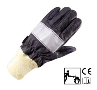
Günstige Basismodelle mit hitzebeständigem und imprägniertem Spezialleder in der Innenhand und einem Innenfutter aus KEVLAR®. Rückhand aus NOMEX® mit aufkaschiertem Filz aus KEVLAR® und einem Reflexstreifen aus 3M Scotchlite™ in silber. Ring- und Karabinerhaken beim Stulpenmodell. Strickstulpe beim Modell FB-CS aus KEVLAR®.
