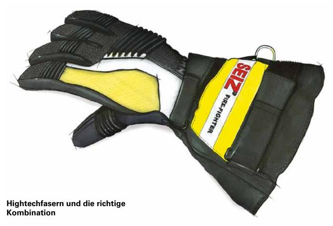
Verantwortlich für den neuen, komfortablen Schutz ist in erster Linie die Verarbeitung von Hochleistungsfasern wie NOMEX® für guten Hitzeschutz, KEVLAR® für guten Schnittschutz und einer GORE-TEX® Membrane für atmungsaktive Eigenschaften. Jede dieser Materialien verfügt über ein
